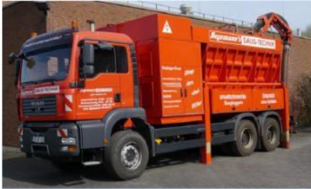
Ausbau alte Schüttung aus Biofor (Biolit)
