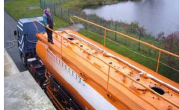
Hydraulische Befüllung aus Silotransporter
